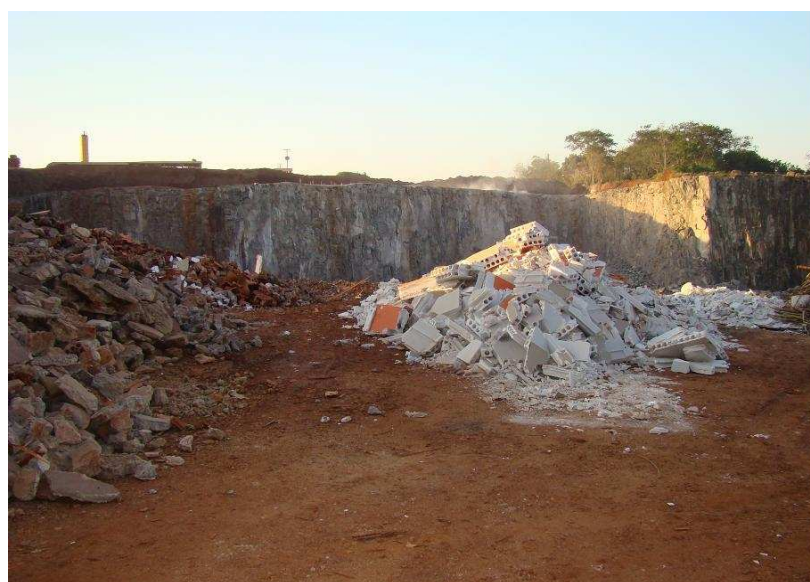
Figura 4. Resíduos classe A e C Fonte: Unidade Coletora de RCD's (2009)
