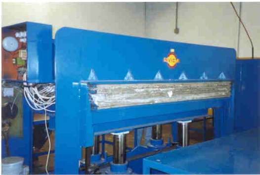
Figuras 2 e 3. Prensa e formas usadas para fabricação de placas e telhas.
