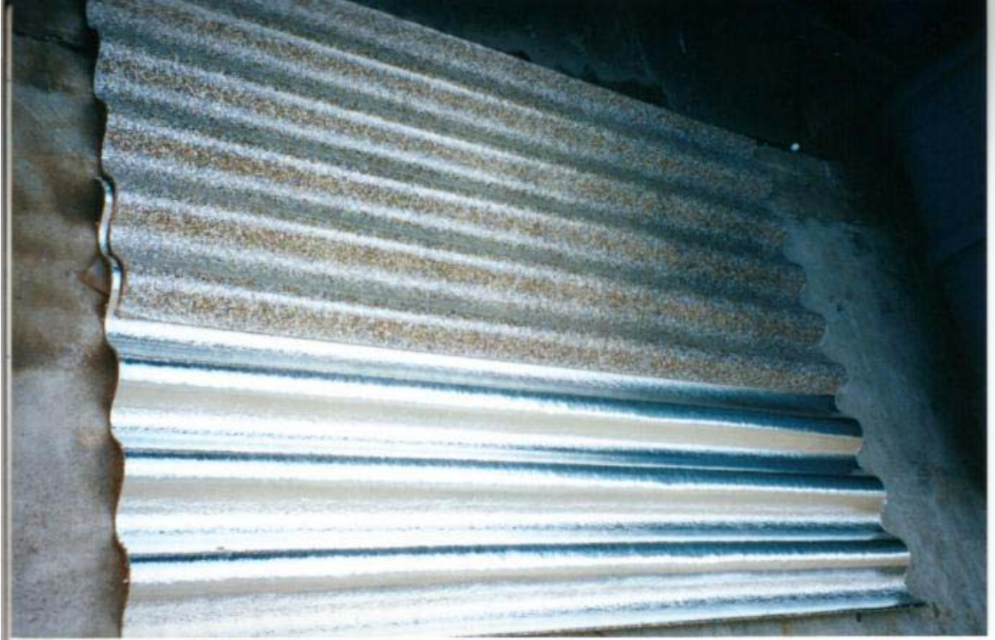
Figura 1. Telhas produzidas com polietileno / alumínio das embalagens Tetra Pak, a primeira “in natura” e a segunda com recobrimento aluminizado.
