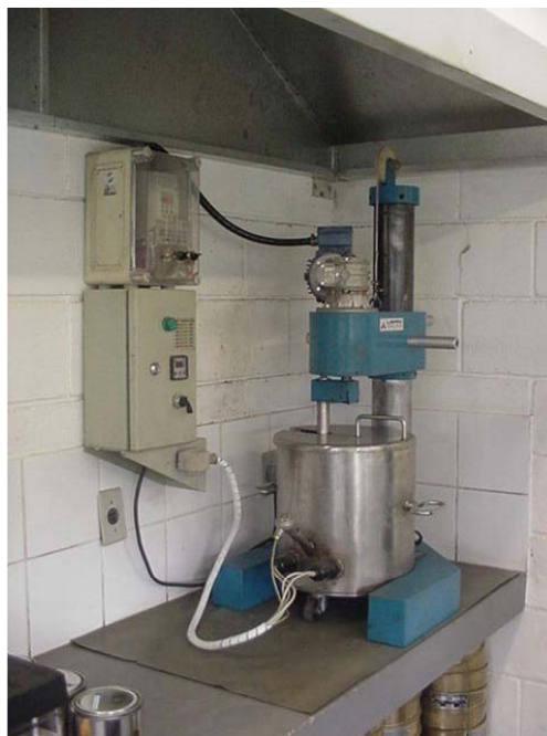
Figura 3.9: Batedeira mecânica com cuba aquecida do LAPAV, utilizada para mistura.
