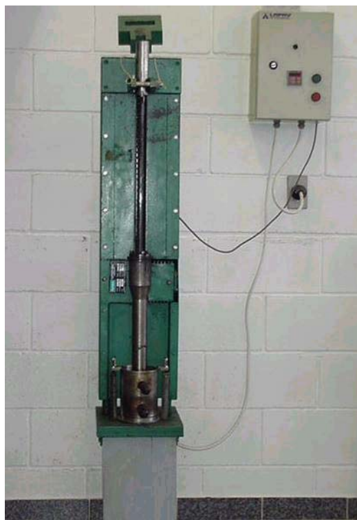
Figura 3.10: Compactador mecânico utilizado para compactação dos corpos-de-prova Marshall.
