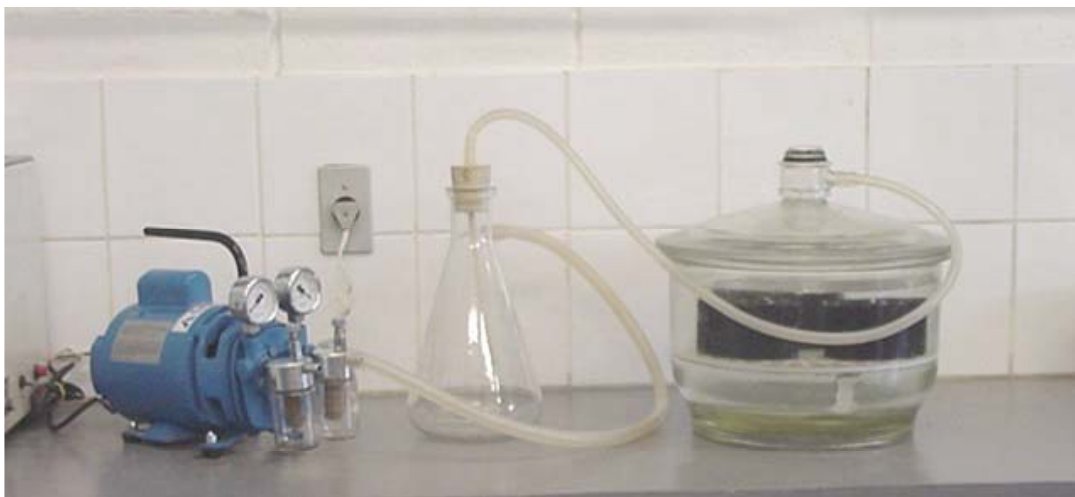
Figura 3.14: Equipamento para saturação dos corpos-de-prova, através da Metodologia Lottman Modificada.
