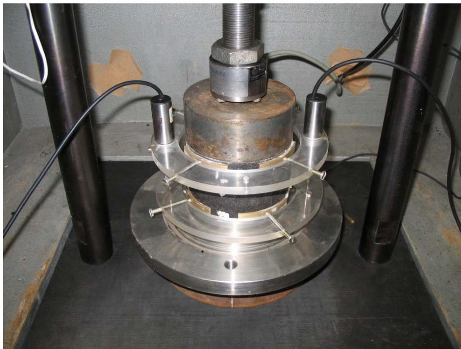
Figura 3.13: Sistema de fixação dos corpos-de-prova e medição do deslocamento para ensaio de compressão uniaxial sob carga repetida.
