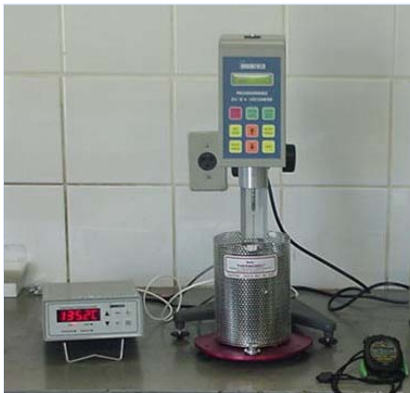
Figura 3.2: Viscosímetro Brookfield, utilizado para verificação da viscosidade do CAP.
