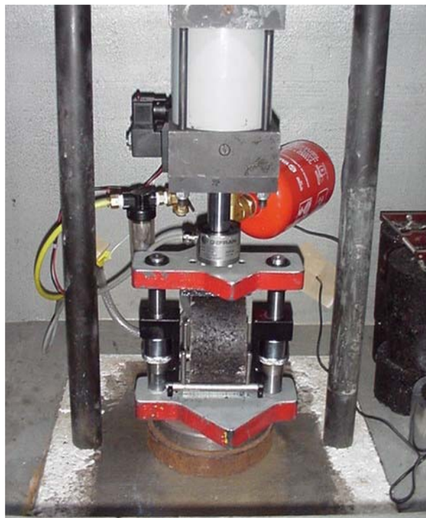
Figura 3.11: Equipamento para ensaio de módulo de resiliência de misturas asfálticas.
