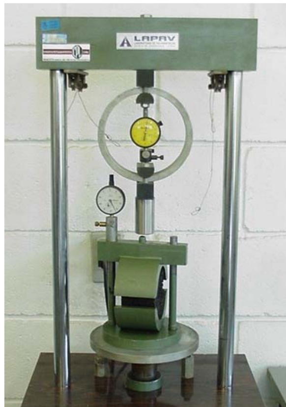
Figura 3.8: Prensa para rompimento dos corpos-de-prova Marshall do LAPAV.
