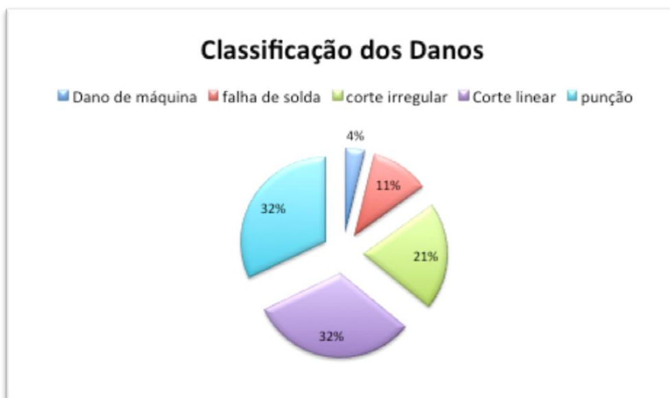
Fig. 5: Classificação e percentual de ocorrência dos principais danos encontrados na geomembrana das áreas inspecionadas pelo Soil Survey .
