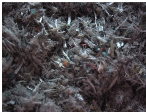
Figura 2. Imagem microscópica da amostra da sucata eletrônica contendo fios de cobre, após a operação de fragmentada.
